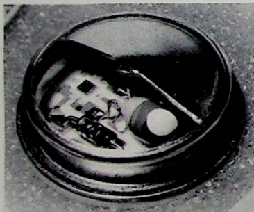
Bild 5. Integrierter Halbleiterverstärker im Verstärkergehäuse (aufgeschnitten)
