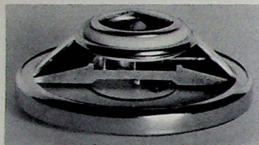
Bild 4. Aufgeschnittene Mikrofonkapsel; von unten nach oben: Membran, piezoelektrischer Schallwandler, Verstärkergehäuse
